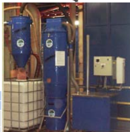
Bilden visar exempel på returspolning av stoft tillbaka till cyklon i en pulverlackering.
