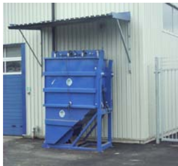
Bilden visar filterenhet med nivåvakt
