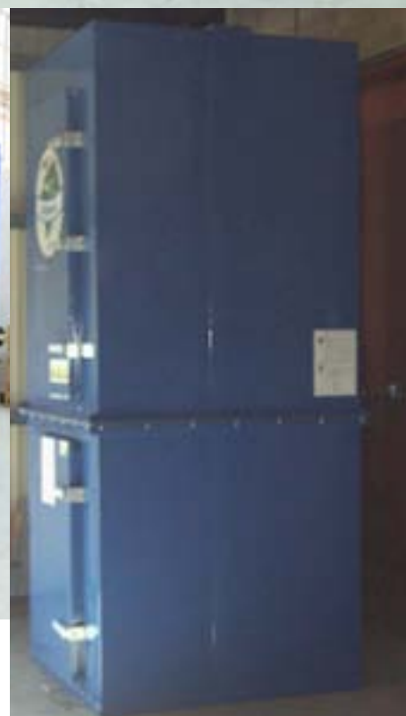
Bilden visar exempel på Dust filterenhet med filteryta 15m 2 och uppsamling av träspån/damm i invändig säck.
